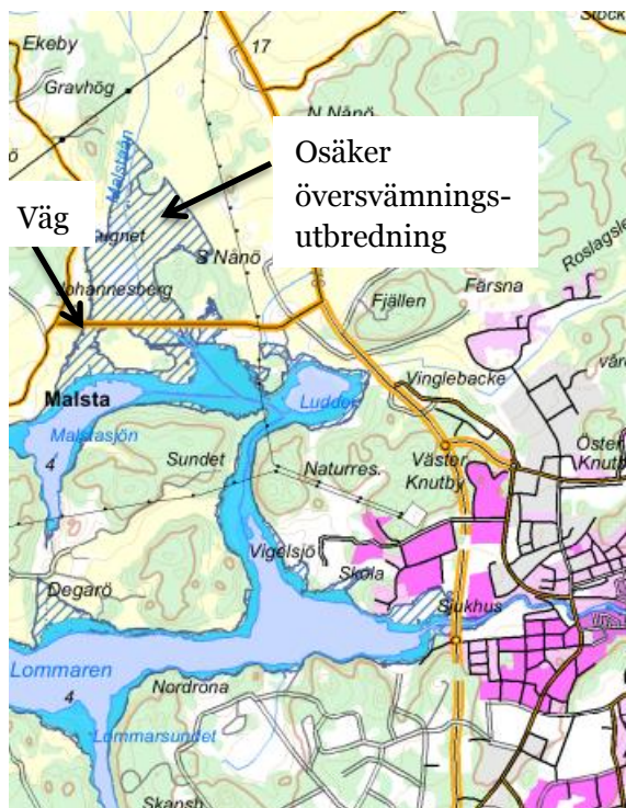
Figur 1 Område i ett av biflödena i Norrtäljeån där översvämningsutbredningen klipps vid beräknat högsta flöde.
